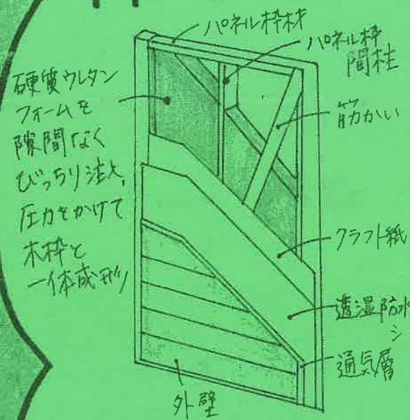
柱(Frame)の間に断熱パネル(Panel)を入れることからFPの家といいます。元々は断熱パネルを柱間に埋め込み隙間を埋めることに徹底的にこだわった家です。この隙間がなく元々は箱が、魔法瓶のような保温性を生み出します。
